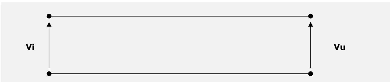
In questo modello un segnale viene trasferito dall'ingresso all'uscita senza distorsione (deformazione della sua forma).
