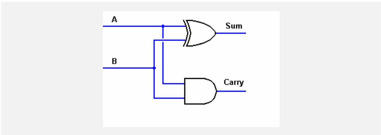
Lo schema si riferisce ad un singolo bit e va ripetuto per ogni bit del dato sommando il riporto al bit di peso superiore (FULL ADDER). Il sommatore diventa così a tre bit (un bit del primo operando, un bit del secondo operando ed il bit di carry dell'adder di peso inferiore) ed è rappresentato nello schema successivo.
