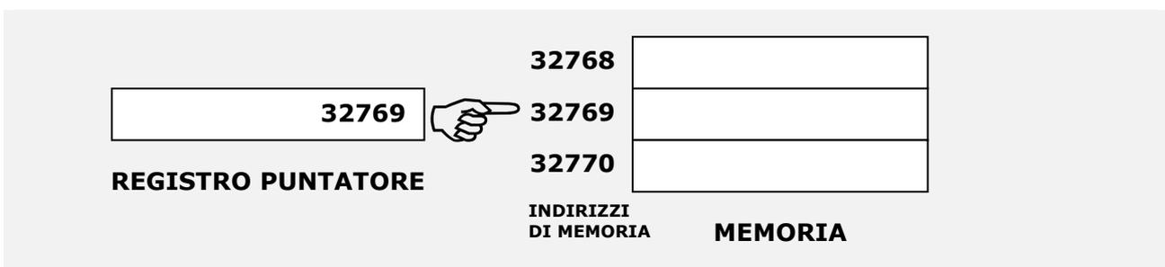
Viene incrementato automaticamente dalla CU (Control Unit) ogni volta che l'esecuzione di una istruzione è completata in modo da potere leggere in memoria l'istruzione successiva.
